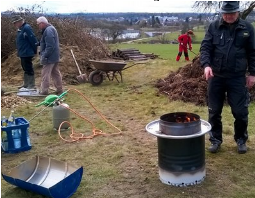
Beim Brennen von Pflanzenholzkohle: Der blaue Behälter ist eine „Kon-Tiki“-Wanne, rechts ein aus zwei Fässern selbst hergestellter Pyrolyseofen. Unten sind die Löcher für die Luftzufuhr zu sehen.
