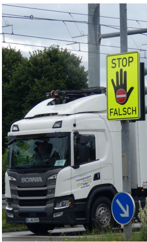
Einer der Test-Lkw beim Stopp an der Ampel, gerade mit abgesenktem Stomabnehmer, mit recht treffender Frage auf dem Schild; Alle Fotos: Heiko Jacobs
