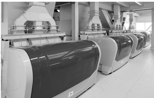
Optische Sortieranlagen im Recyclingwerk
